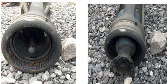
Hình 3. Hư hỏng tại buồng cắt pha B
